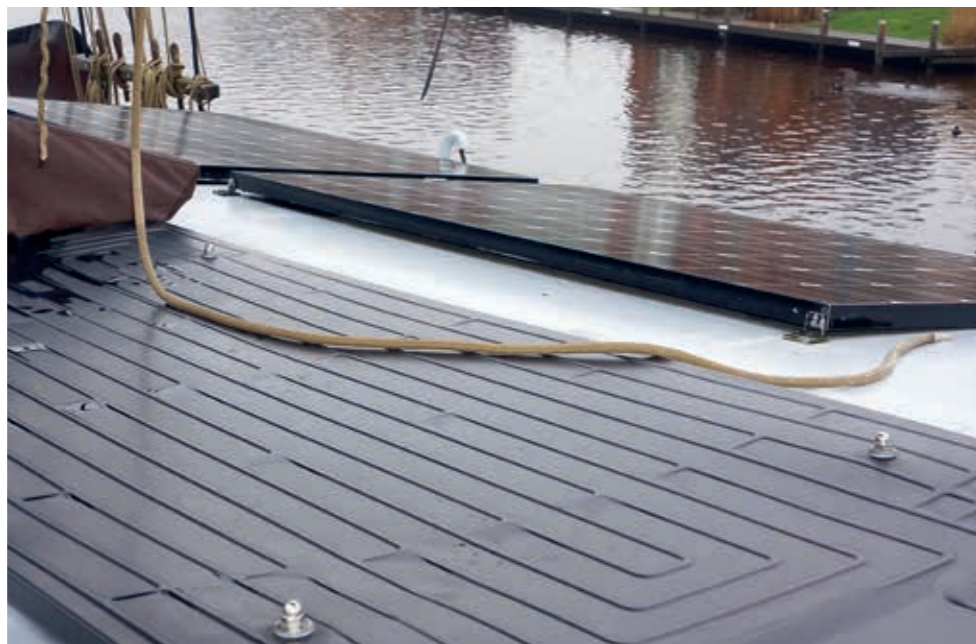
boven: Het warmwatersysteem op het roefdak. Erachter liggen de zonnepanelen
